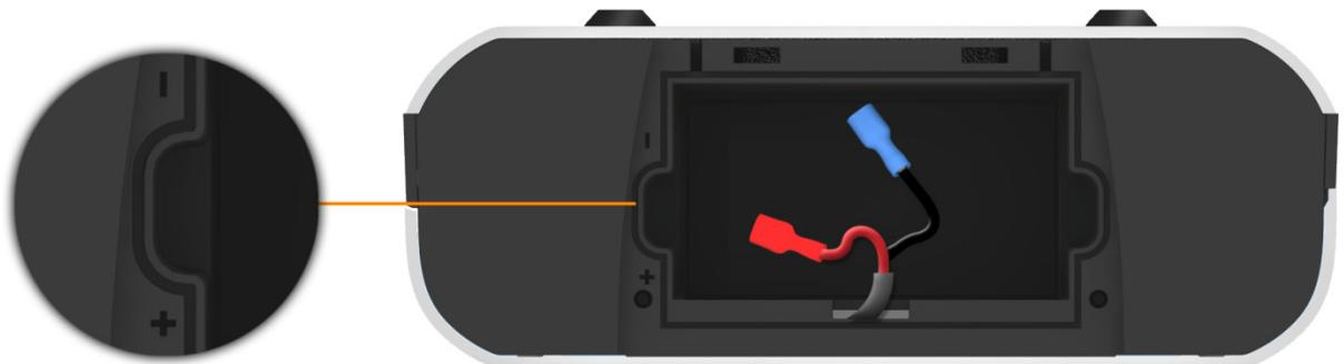
4. Schließen Sie die Batterie an das Batteriekabel an. Halten Sie sich dabei an die oben beschriebenen Farbkodierung.
