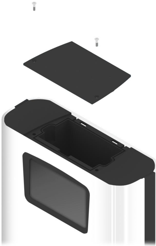
3. Legen Sie die Batterie in das Batteriefach ein. Im Batteriefach finden Sie auf der Oberfläche die Symbole + und -, um die richtige Ausrichtung der Batterie zu erleichtern. Die rote Batterieklemme muss am +, die schwarze Batterieklemme am - anliegen.
